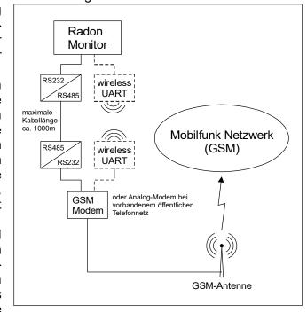
Relaisstation (Funk oder Kabel) zwischen Modem und Gerät u.U. die preiswertere Lösung ist. Diese Variante empfiehlt sich auch bei Messorten in Bergwerken, Höhlen usw., wenn dort kein Telefonnetz verfügbar ist. Entsprechende Konverter stehen ebenfalls kommerziell zur Verfügung.
