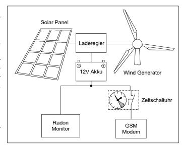
Witterungsbedingungen zu erwarten sind. Bei der Dimensionierung muss beachtet werden, dass unter realen Bedingungen die durchschnittliche Leistung des Solar-Panels, abhängig vom Standort, zwischen 5% und 30% der angegeben Spitzenleistung beträgt. Die Batteriekapazität muss groß genug sein, um auch bei anhaltenden Schlechtwetterperioden eine Versorgung zu gewährleisten.
