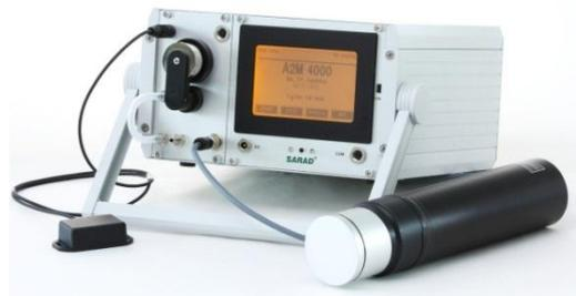
Mit dem A<sup>2</sup>M4000 kommt erstmals ein portables und batteriebetriebenes Gerät auf den Markt, welches verschiedenste Detektoren und Komponenten für nahezu alle Messaufgaben im Strahlenschutz in sich vereint.
