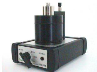
Mit der VacuTube lassen sich die Vielkanalanalysatoren der Serie SPECTRA 5011/5031 einfach und preiswert zu einem Vakuum Alpha-Spektroskopiemessplatz erweitern.
