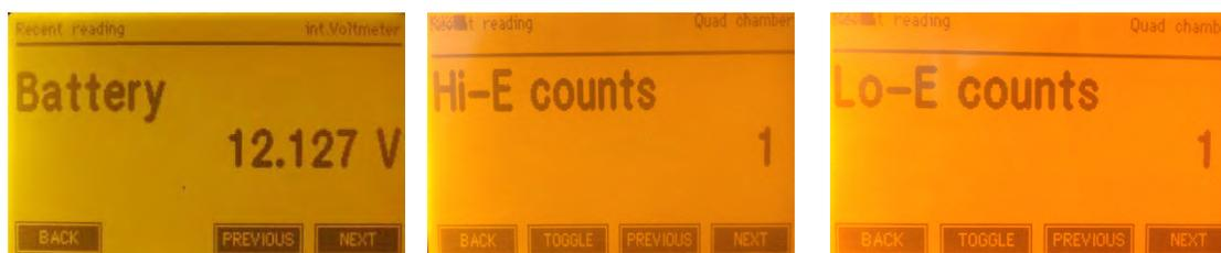
继续点击 PREVIOUS 或者 NEXT 前后翻页显示其他数据，如图所示，分布为电池电压，高能计数（ $\alpha$ 计数），低能计数（ $\beta$ 计数）。图中有“TOGGLE”的还能显示更多相关数据。数据显示更新时间为 1 秒（氡浓度相关数据更新时间较长）。
