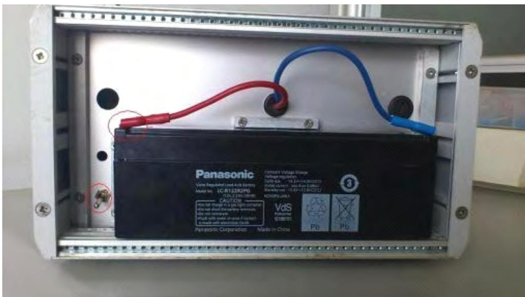
取下后盖之后，拨动开关关闭电源，并轻轻将红色电源线拔出。然后合上后盖，旋紧后盖螺丝即可。当需要重新启用仪器时，可按照类似操作连接并启动电源。
