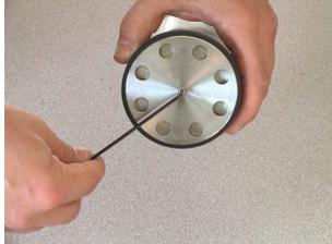
Lösen der Innensechskantschraube an der Bodenplatte entgegengesetzt dem Uhrzeigersinn. Die Schraube muss dabei nicht vollständig herausgedreht werden. Die Innensechskantschraube presst die innere Dichtplatte gleichmäßig gegen die Membran!
