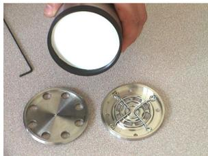
Herausnehmen der lose einliegenden inneren Dichtplatte und des Stabilisierungsgitters. Die Diffusionsmembran ist jetzt zugänglich und kann herausgenommen werden. Dabei dürfen keine scharfkantigen Werkzeuge verwendet werden, da sonst die Dichtflächen beschädigt werden können.
