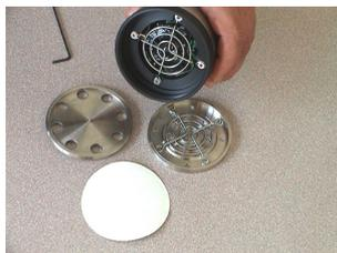
**ACHTUNG!** Auch nach dem Trennen der Sonde von der Stromversorgung liegt noch für eine gewisse Zeit Hochspannung an Teilen der Sondenelektronik. Diese ist mit einem zusätzlichen Schutzgitter vor Berührung geschützt.
