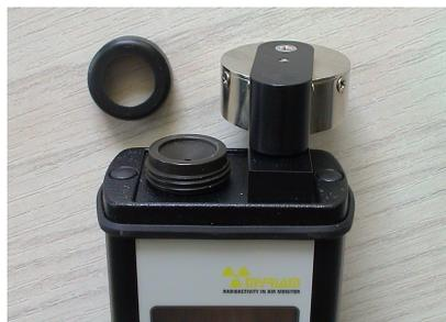
Zum Wechsel des Filters ist zunächst die Madenschraube an der Rückseite des Schwenkarmes zu lösen, so dass der Messkopf nach hinten weggeschwenkt werden kann und der Luftansaugstutzen frei zugänglich ist. Achtung: Der Messkopf darf nicht mehrfach gedreht werden, da sonst die innenliegenden Kabelverbindungen zerstört werden können. Eine Berührung des Detektors an der Unterseite des Messkopfes ist unbedingt zu vermeiden.
