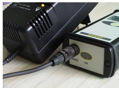
Zum Laden des Akkus wird zunächst das Ladenetzteil in die Steckdose gesteckt. Danach wird der Stecker des Ladegerätes in die Ladebuchse am unteren Deckel des DOSEman-PRO gesteckt. Die rote Anzeige blinkt für wenige Sekunden (Test des Ladezustandes). Danach leuchtet die rote Anzeige kontinuierlich während des gesamten Ladevorgangs. Am Ende des Ladevorgangs verlischt die rote Anzeige und die grüne Anzeige leuchtet auf.
