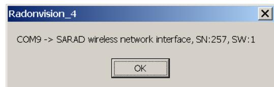
Messgeräte, die sich im Empfangsbereich des Koordinators befinden und über eine ZigBee Schnittstelle verfügen werden automatisch erkannt. Wenn Messgeräte erst innerhalb des Netzbereiches eingeschaltet bzw. von außerhalb in den Netzbereich verbracht werden, dauert der Erkennungsvorgang einige Sekunden.
