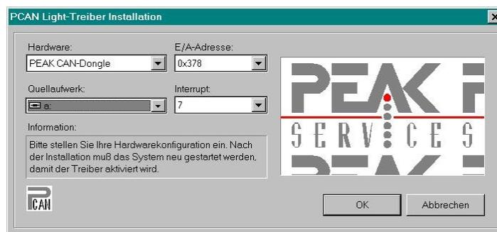
Abbildung 4: Dialogansicht zur Konfigurierung des CAN-Treibers PEAKCANL.VXD
