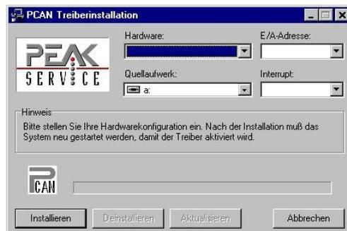
**Abbildung 5: Dialogansicht zur Konfigurierung des CAN-Treibers PEAKCAN.SYS**
