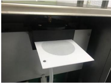
卡片式滤膜从前方插入，位于滤膜托与滤膜密封盖之间。滤膜位置通过固定栓定位，不会有前后左右偏移。固定栓位于滤膜左侧，防止滤膜正反面颠倒放置。更换时先拔出固定栓，然后才能取出滤膜，随后放入新滤膜，重新从上部插入固定栓。固定栓插入到底后，滤膜不可移动。
