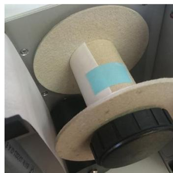
用于测试，可以启动预设的自动走纸方案(Insert Filter)，使滤膜自动往前行进几格。可以观察到滤膜被自动卷至空滤膜卷筒上。随后可以关上柜门，锁定完成。
