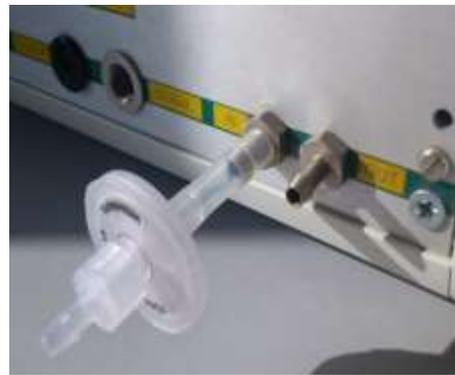
图 1.2.4 安装好的过滤器
