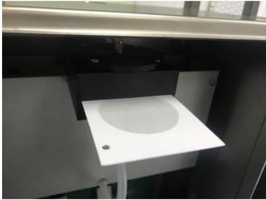
Die Filterkartusche wird von vorn in den Schlitz zwischen Filter-Support und Filterdichtplatte eingeschoben. Die Position der Filterkartusche wird durch einen Stift gesichert. Außerdem verhindert der Stift die versehentliche Nutzung der falschen Filterseite. Nach dem Herausziehen des Stiftes kann die Filterkartusche entnommen und eine neue eingesetzt werden. Der Stift ist von oben bis zum Ring in die dafür vorgesehene Bohrung einzuschieben. Die korrekte Fixierung des Filters sollte
