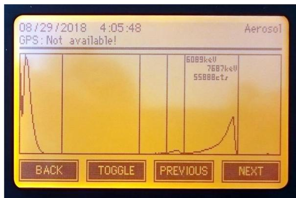
Das Radon Folgeprodukt Spektrum (Beispiel in obiger Abbildung) enthält maximal vier signifikante Peaks, für die folgende Kriterien hinsichtlich Peakfläche, Form und Lage gelten:
