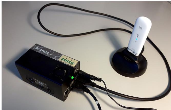
Abbildung 2.2: *Aranea LTE* mit über die USB-Verlängerung angeschlossenem LTE-Modem. Die USB-Verlängerung kann vom Foto abweichen.
