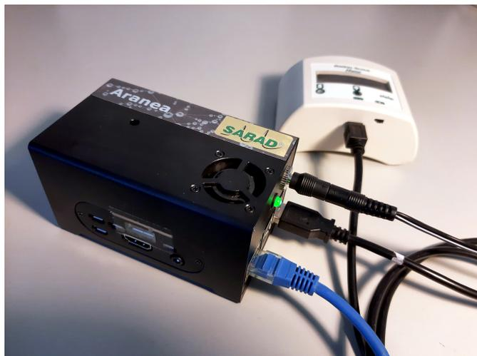
Abbildung 2.3: *Aranea LAN* mit angeschlossenem Steckernetzteil und über USB verbundenem Messgerät. Das blaue Ethernetkabel stellt die Verbindung ins LAN her.
