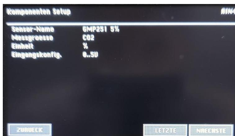
Abbildung 7: Komponenten-Konfiguration
