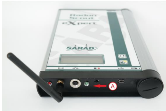
Abb. 3. – Schiebschalter (A) auf linke Position (keine Messung) und warten bis das Gerät in den Standby-Modus geht (keine Anzeige).
