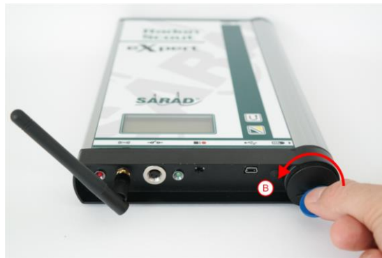
Abb. 4. – Lösen des Deckels (B) an der Gerätevorderseite.
