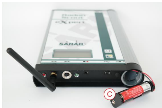
Abb. 5. – Neue Batterien einsetzen (C). Auf korrekte Polarität achten!
