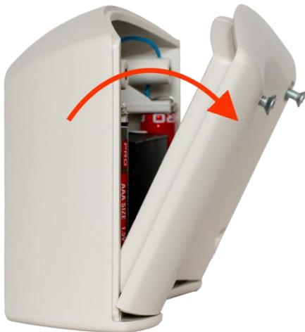
Abb. 5. – Rückwand durch leichtes Kippen an der Rundung abnehmen.
