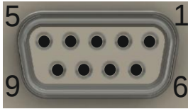
RS232 (SUB-D Buchse, 9-polig)
