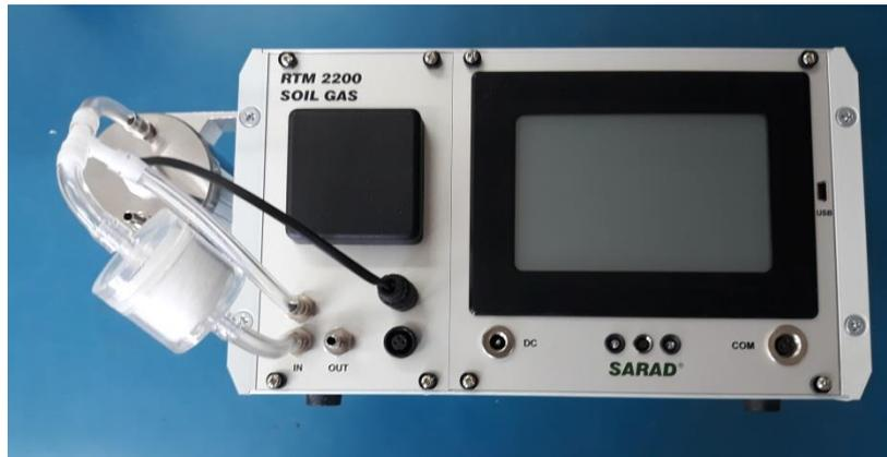
Der Filter sollte bei Anzeichen einer Verschmutzung gewechselt werden, da in diesem für das Ansaugen der Luftprobe eine höhere Pumpenleistung erforderlich ist. Dadurch wird der Messbereich der Bodenluftsonde in Richtung geringer Permeabilität eingeschränkt.
