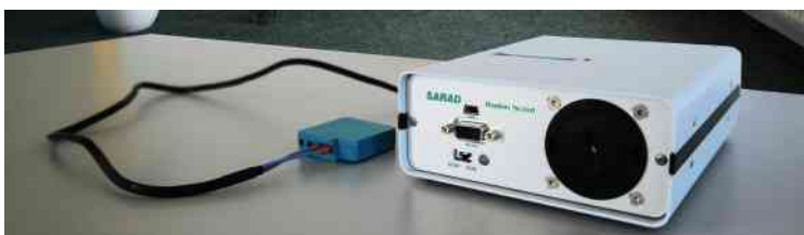
Mit der Lüftungssteuerung «Radon Scout» von der Sarad GmbH können Lüftungsgeräte angesteuert werden, wie z. B. ein aussenliegender Ventilator, der einen leichten Unterdruck unter der Bodenplatte erzeugt.
