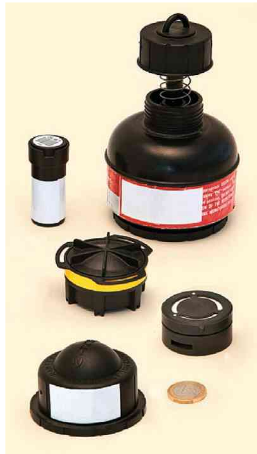
Verschiedene Dosimeter zur Bestimmung der mittleren Radonkonzentration über eine Messperiode von etwa drei Monaten. (Bild: Radon, Einfluss der energetischen Sanierung, BAG, 2012)
