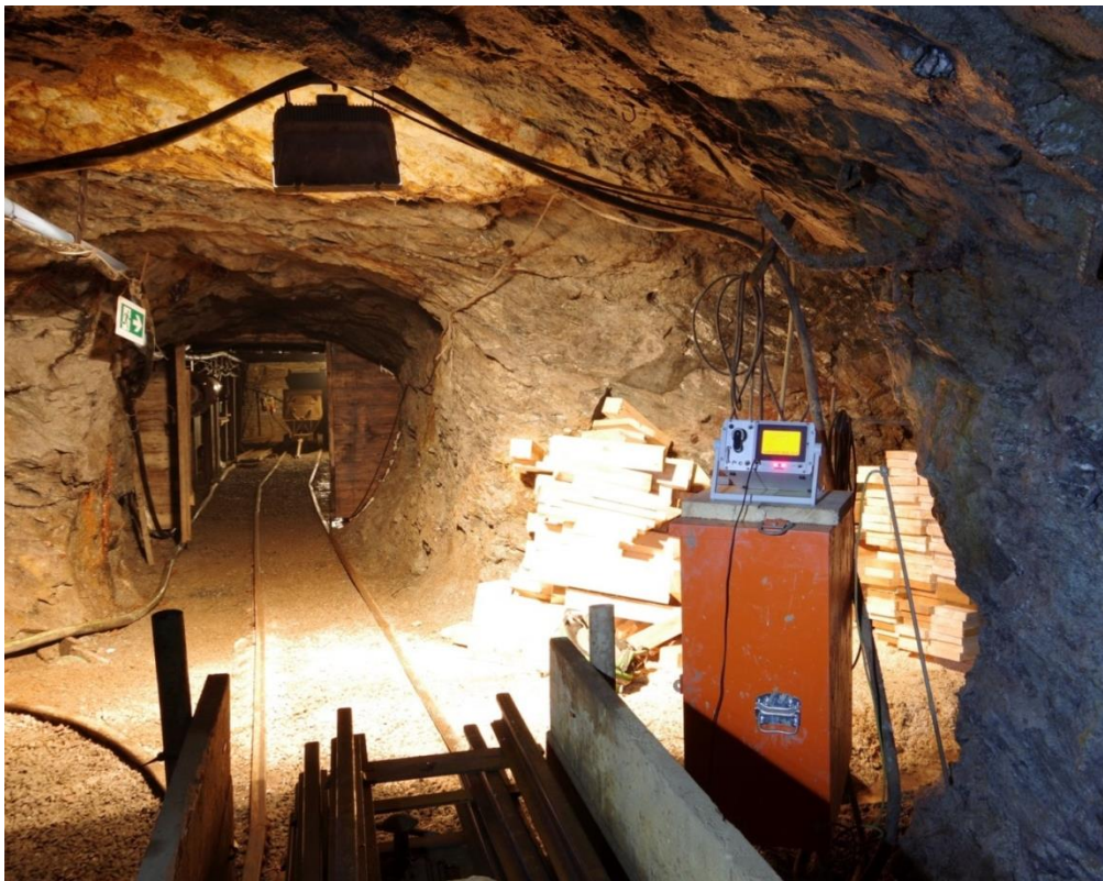
Abb. 1: Messung von Radonfolgeprodukten im Querschlag 24 in Schneeberg mit einem Radonmonitor EQF 3200
