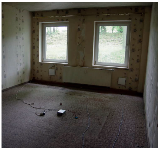
Abb. 2: Versuchsaufbau in einer Wohnung eines leergezogenen Wohnblocks mit zwei Lüftungsgeräten iV14-Zero und einem Radonmonitor Radon Scout Plus mit Funkgeber im Wohnzimmer (links) und mit dem Regler MZ-Home mit Funkempfänger sowie einem Radonmonitor Radon Scout Plus im Flur (rechts)
