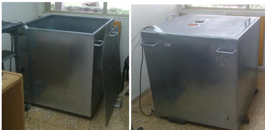
**Figura 1. Cámara de radón de 1 m<sup>3</sup> de volumen abierta y cerrada (LaRUC).**
